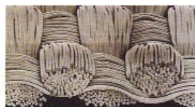
78 dtexes filamentfonalak, 98 db filamentág, 0,8 dtex/filament
