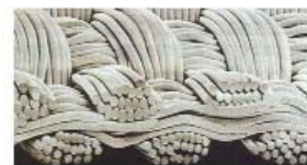
78 dtexes filamentfonalak, 23 db filamentág, 3,4 dtex/filament
